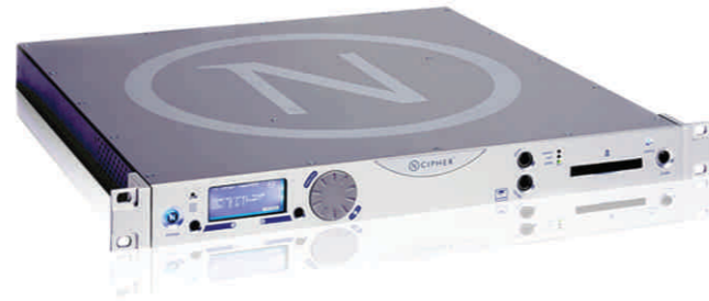
Thiết bị an ninh phần cứng (HSM) tiêu chuẩn FIPS PUB 140-2 mức 3.
